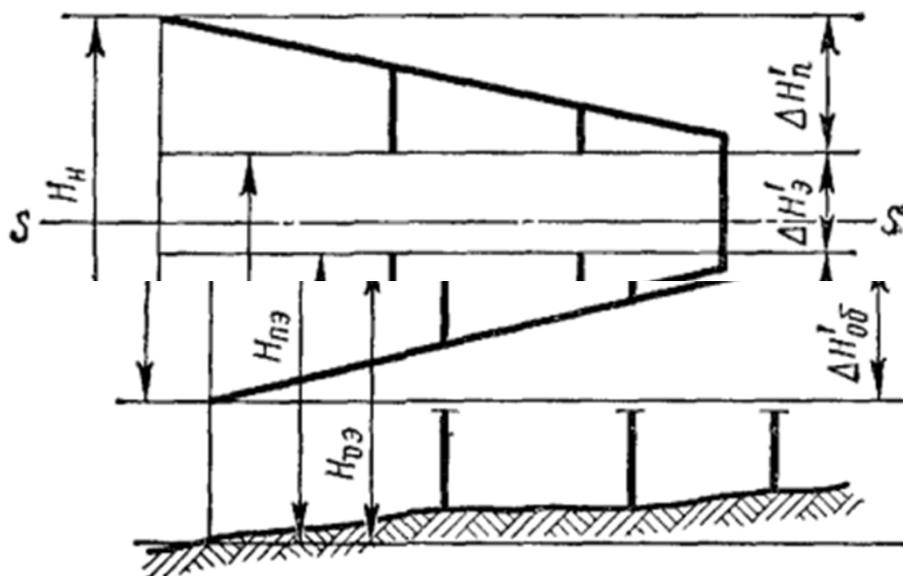
**Рисунок 5 - Пьезометрический график тепловой сети при пропорциональной разрегулировке абонентов.**
